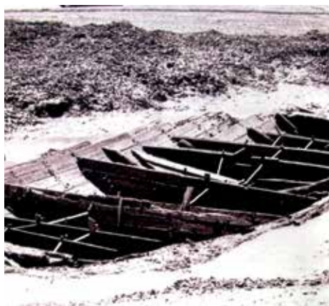
Excavaciones de un junco de la dinastía Song mostrando los mamparos de sus compartimentos estancos. En: Els grans viatges de Zheng He , p. 68
